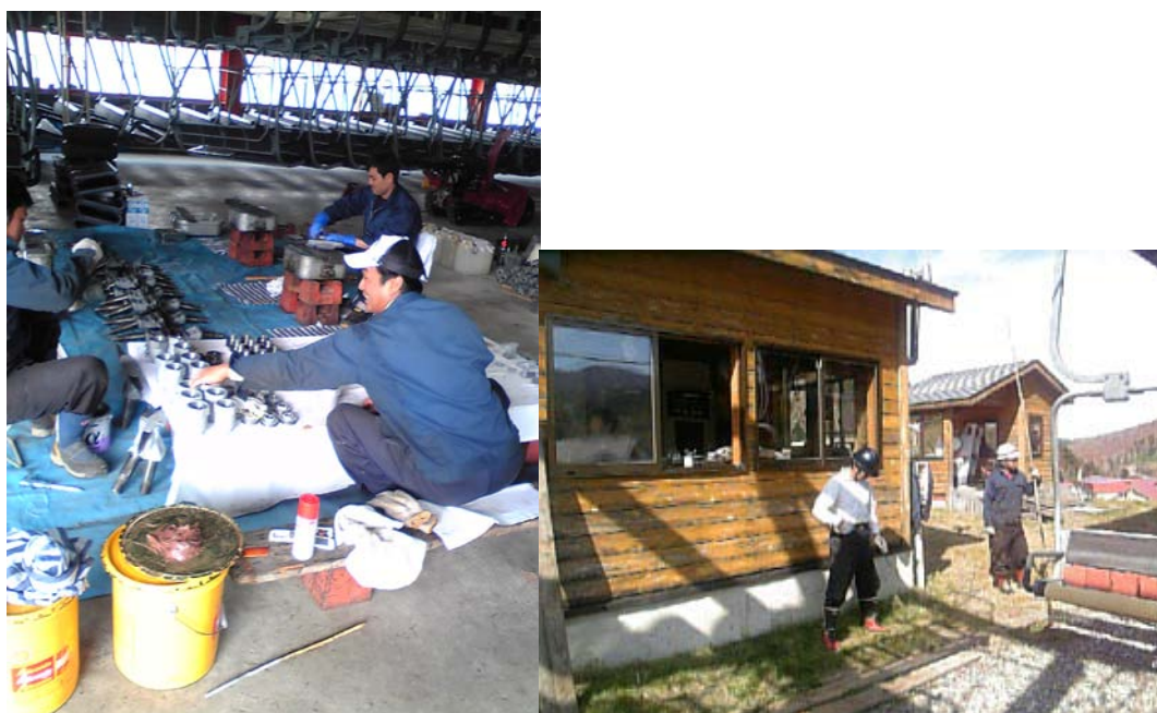
固定循環握索装置整備状況
